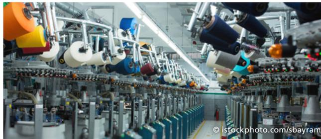
die spätere Durchfärbung optimiert wird. Vor allem die Validierung des Materialmodells durch CT-Aufnahmen real gewickelter Spulen steht hier im Fokus. Aus der optimierten virtuellen Spule werden letztlich die Einstellparameter für die Spulmaschine abgeleitet.
