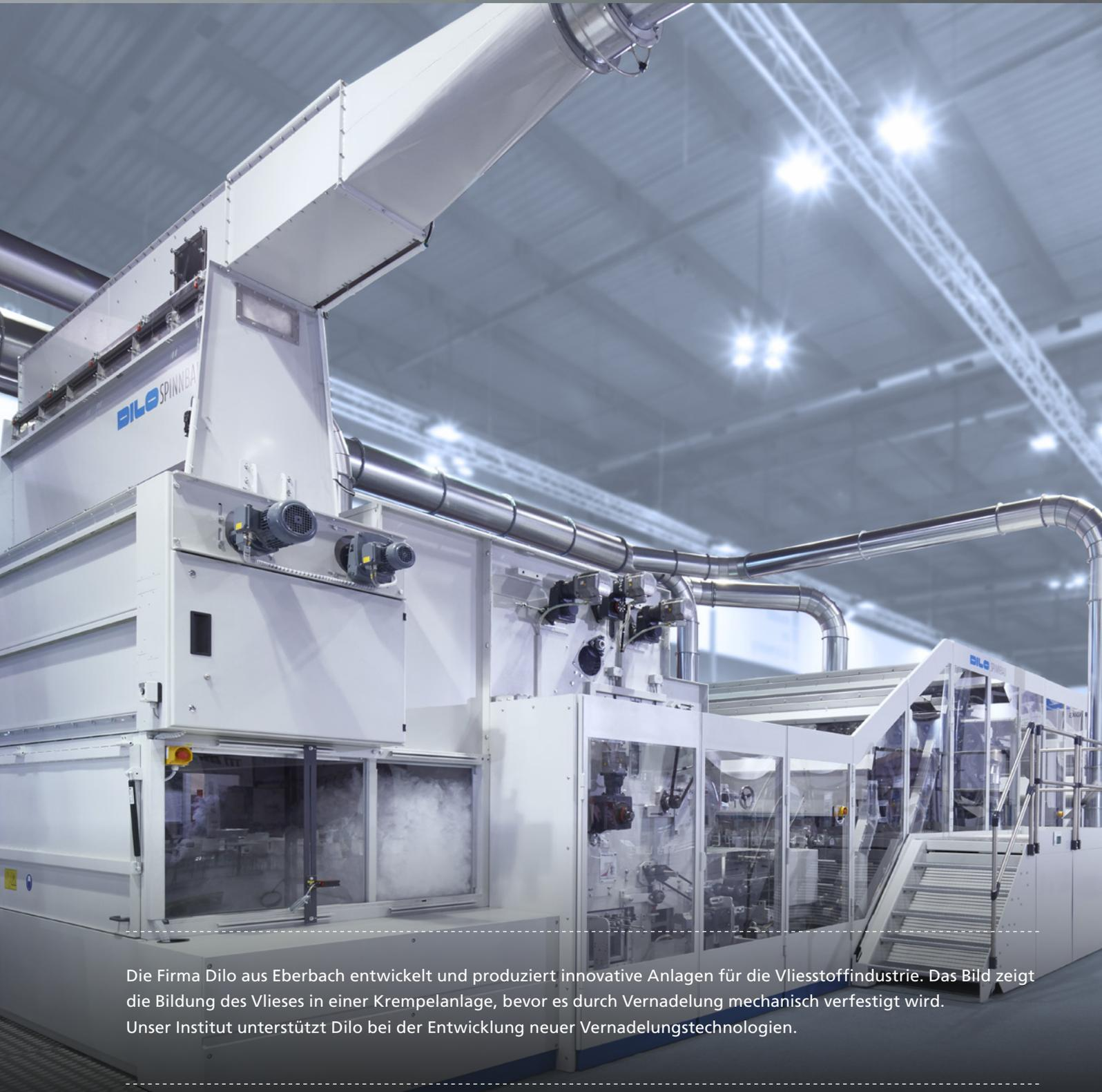
Die Firma Dilo aus Eberbach entwickelt und produziert innovative Anlagen für die Vliesstoffindustrie. Das Bild zeigt die Bildung des Vlieses in einer Krempelanlage, bevor es durch Vernadelung mechanisch verfestigt wird. Unser Institut unterstützt Dilo bei der Entwicklung neuer Vernadelungstechnologien.
